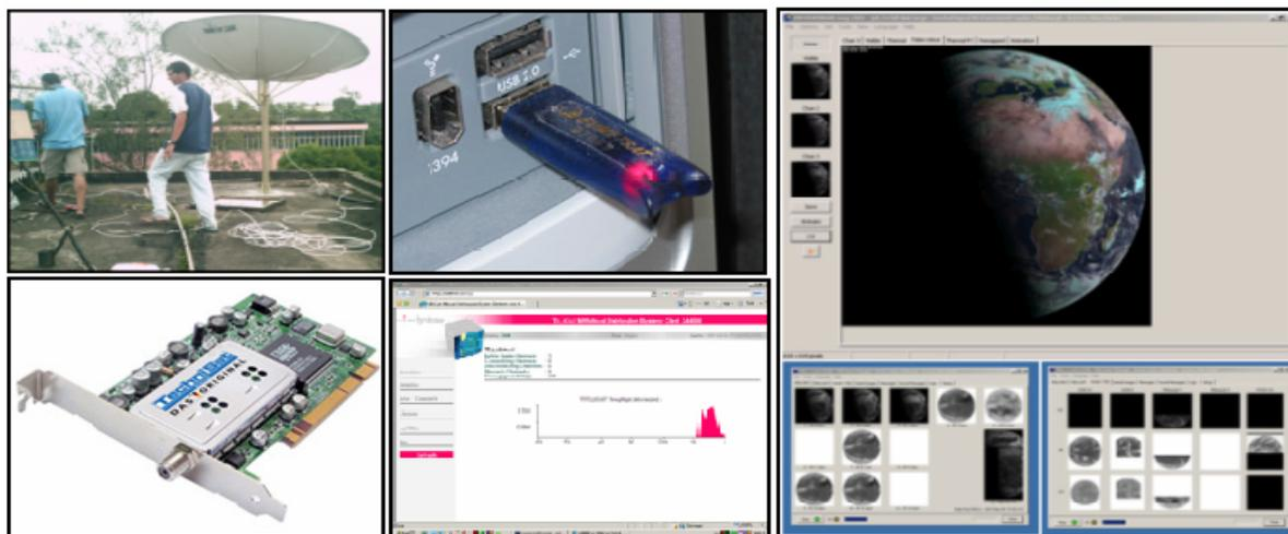
Figura 1 - Equipamentos e softwares usados para montagem da Estação de recepção de imagens do satélite METEOSAT-9 (MSG) na UFAL. Fonte: Humberto Barbosa.
